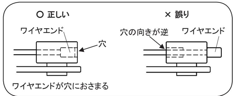
② スロットルワイヤの取付が終わったら必ずコントロールレバーとスロットルレバーを操作し、動作の確認を行ってください。スロットルレバーから手を離した際、キャブレタの扇状部品がアイドルスクリュに接していることを確認してください。扇状部品とアイドルスクリュの間にすき間がある場合、スロットルワイヤ（アウタ）がトリガースロットルレバーの穴の奥まで入っていない可能性があります。再度ワイヤの取付を確認してください。
