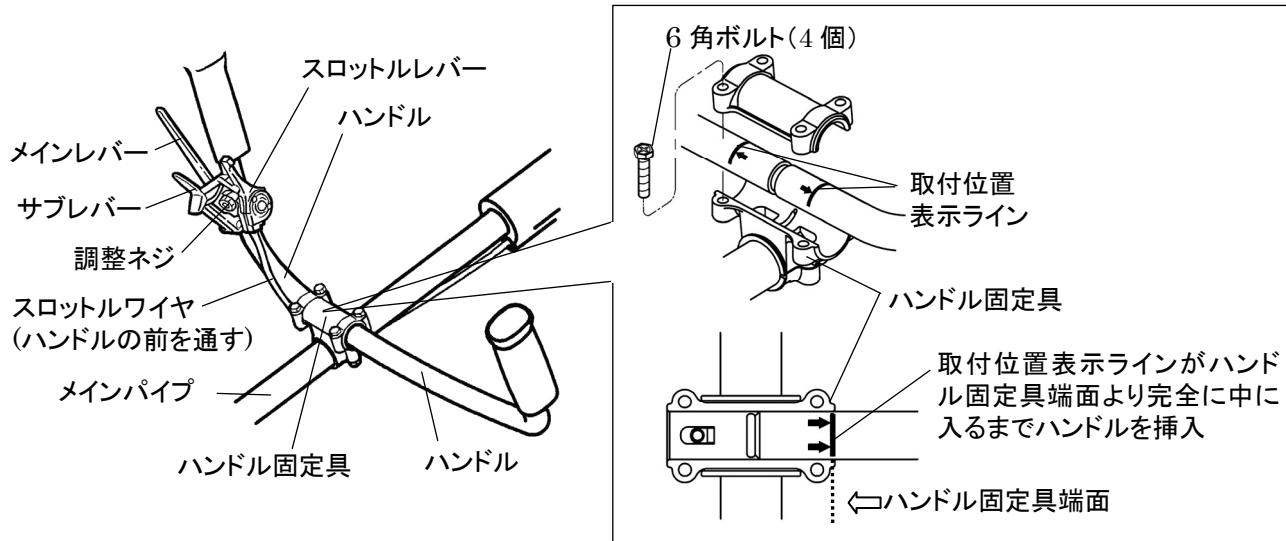
**注意** 前ページ図のように、スロットルワイヤはハンドルの前方に取り回してください。図の通り組み立てないと、トリガースロットルレバーが正常に作動しません。
