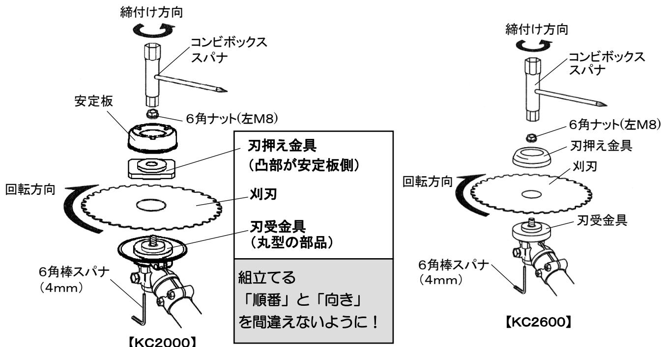
③ 刃受金具の凸部と刈刃の取付け穴を合わせてください。刈刃、刃押え金具、安定板※1、6角ナット（左M8）の順に取付け、6角棒スパナ（4mm）を差し込み刃受金具を回らなくしてから付属のコンビボックススパナで左に回して、ナットを確実に締め付け刈刃を固定してください。
