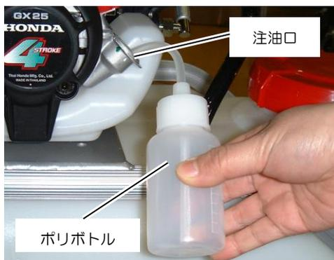
④注入後、オイル給油キャップをゆるまないように確実に締付けます。
