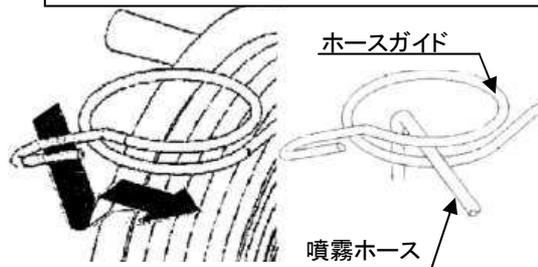
ホースガイドのノズルホルダ部をかわしてホースガイド螺旋部の隙間を通すことで、噴霧ホースをホースガイドから取り外します。
