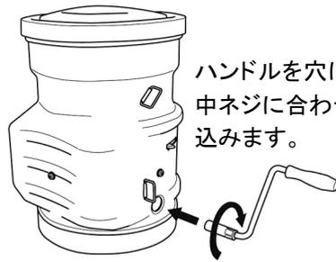
ハンドルを穴に差し込み、中ネジに合わせねじ込みます。
