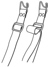
バンドを本体の取付け金具に引掛け、本体が体に密着するように長さを調節してください。
