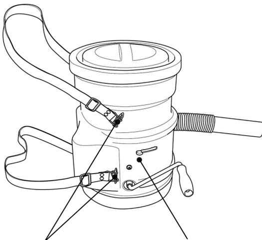
バンドの取付け部分上下に取り付け。
