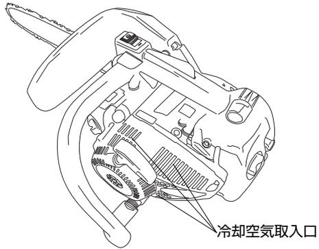
このエンジンは強制空冷式です。冷却用の空気取入口やシリンダフィンの中にゴミが詰まるとエンジンの冷却不良が発生し、エンジンが過熱し、故障の原因となります。時々点検し、ゴミを取除いてください。
