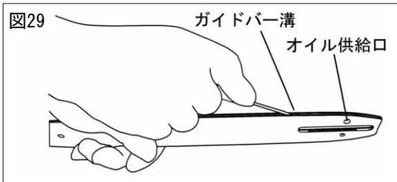
チェンオイルの供給不良を防ぐため、一日の作業が終わった後、ガイドバーとソーチェンを取外して、チェンオイル吐出口周辺に付着しているゴミとガイドバー溝の底にたまったゴミを鉄板等で取除いてください。
