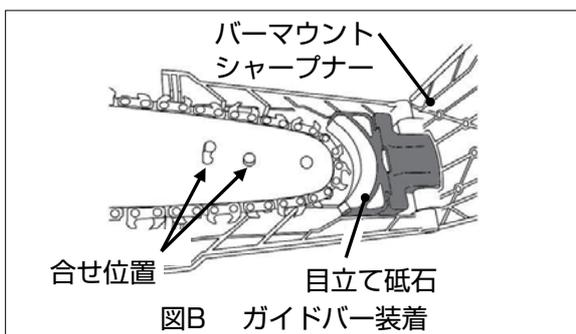
ガイドバー先端の穴をバーマウントシャープナーの2本のピンに合わせてください。(図B)
