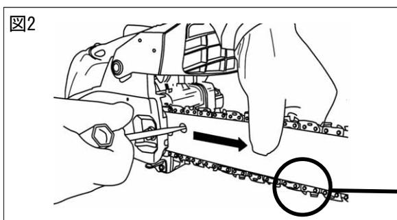
② ガイドバー先端部を持ち上げながら、ガイドバーのチェーン張り調整穴に付属のコンビボックススパナを入れ、右に回してガイドバーを前方に押し出し、ソーチェーンを張ってください。(図2参照)
