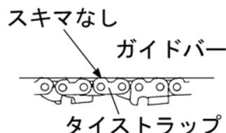
④ ガイドバー先端部を持ち上げながら付属のコンビボックススパナでガイドバー取付ナットを確実に締付けてください。(図3参照)
