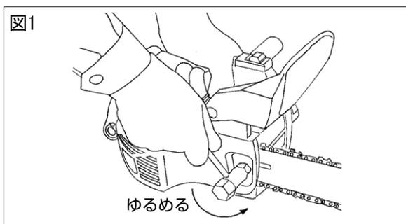
① 付属のコンビボックススパナでガイドバー取付ナットをゆるめてください。(図1参照)
