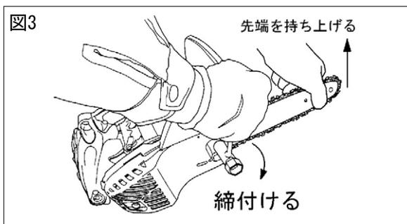
③ ソーチェーンの張りは、ガイドバー先端部を持ち上げたときに、ガイドバーの下側で、ソーチェーンのタイストラップがガイドバーに軽く触れる程度(スキマなし)が適切です。
