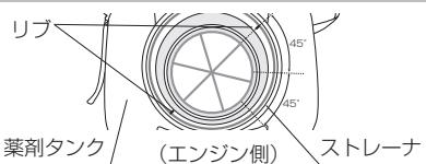
ストレーナの内側の両サイドのリブを水平若しくは垂直の状態で薬剤タンクに設置し、その位置から45°回転させると、ストレーナを薬剤タンクに半固定できます。発泡系の薬剤使用のとき、ストレーナの浮き上がりを防止することができます。
