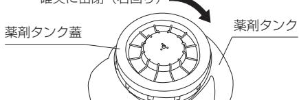
薬剤タンク蓋パッキンを確かめ確実に右に回して密閉します。
