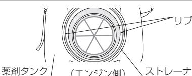
ストレーナの内側の両サイドのリブを薬剤タンクと水平若しくは垂直にすると、ストレーナの脱着ができます。
