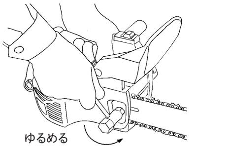
①付属のコンビボックススパナでガイドバー取付ナットをゆるめてください。(図 7-1 参照)
