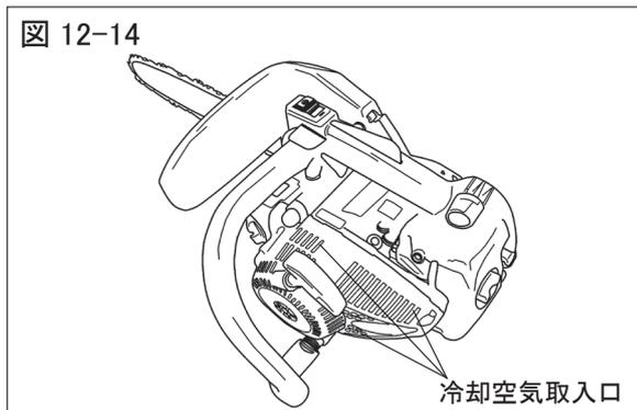
このエンジンは強制空冷式です。冷却用の空気取入口やシリンダフィンの中にゴミが詰まると冷却不良によりエンジンが過熱し、故障の原因となります。時々点検し、ゴミを取除いてください。
