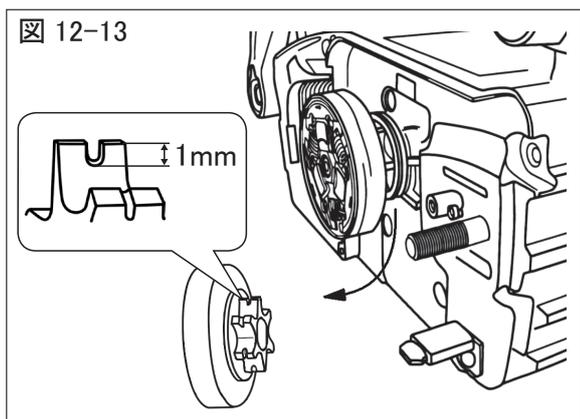
①ガイドバーを取外した時に、クラッチドラム内側のソーチェン駆動スプロケットを点検してください。
