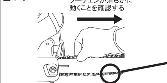
③ソーチェーンの張りは、ガイドバー先端部を持ち上げたときに、ガイドバーの下側で、ソーチェーンのタイストラップがガイドバーに軽く触れる程度(スキマなし)が適切です。(図 7-3 参照)
