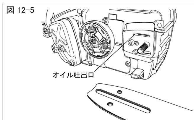
チェンオイルの供給不良を防ぐため、1日の作業が終わった後にガイドバーとソーチェンを取外して、チェンオイル吐出口周辺に付着しているゴミとガイドバー溝の底にたまったゴミを、鉄板等で取除いてください。
