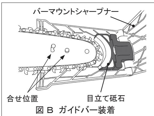
ガイドバー先端の穴をバーマウントシャープナーの2本のピンに合せてください。（図B）
