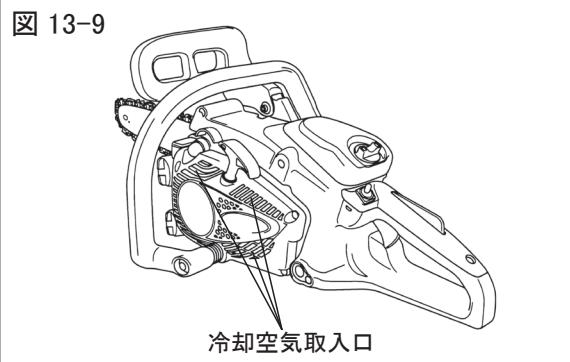
このエンジンは強制空冷式です。冷却用の空気取入口やシリンダーフィンの間にゴミが詰まると冷却不良によりエンジンが過熱し、故障の原因となります。時々点検し、ゴミを取除いてください。
