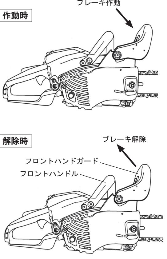
チェンブレーキは、使用中にガイドバーの先端が障害物に当たって上方にハネ返された（キックバック現象）際に、ブレーキが作動してソーチェンの回転を強制的に停止させる装置です。
