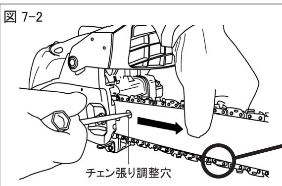
②ガイドバー先端部を持ち上げながら、ガイドバーのチェン張り調整穴に付属のコンビボックススパナを入れ、右に回してガイドバーを前方に押し出し、ソーチェンを張ってください。（図 7-2 参照）
