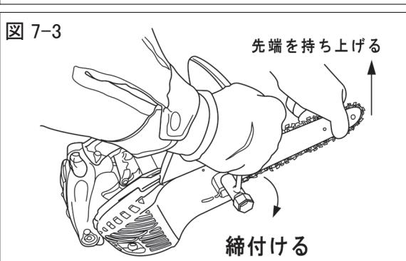
④ガイドバー先端部を持ち上げながら、付属のコンビボックススパナでガイドバー取付ナットを確実に締付けてください。（図 7-3 参照）
