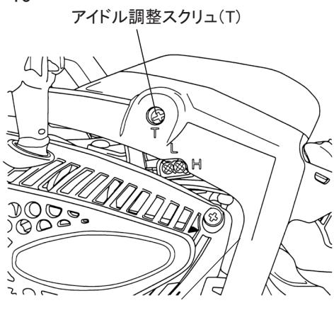
①リヤハンドル左側後部にあるアイドル調整スクリュ (T) を、付属のコンビボックススパナで回してください。右に回すと回転が上がり、左に回すと回転が下がります。
