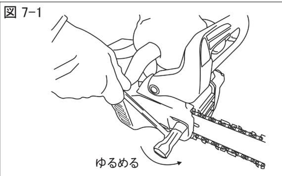
①ブレーキが解除されていることを確認して、付属のコンビボックススパナでガイドバー取付ナットをゆるめてください。（図 7-1 参照）
