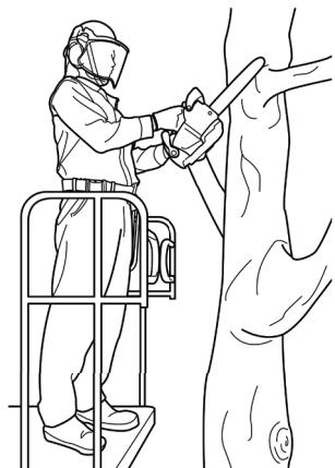
①高所作業用機器（高所作業車、バケット車など）を使用し、安定した足場を確保するとともに、安全帯（ワイヤ芯入りロープ付）を必ず着用し、身体をしっかりと固定してください。
