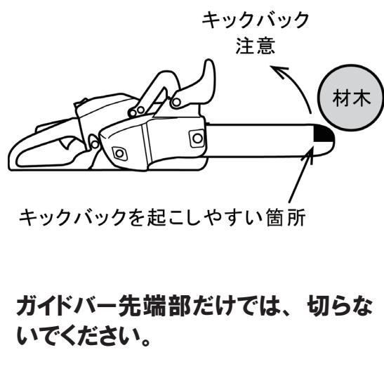
⑦キックバック防止のため、ガイドバー先端部での作業は行わないでください。
