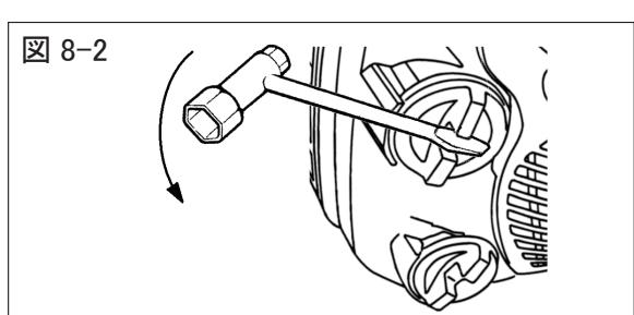
⑤給油が終わったらキャップを確実に締付け、漏れがないことを確認してください。
