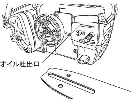
チェンオイルの供給不良を防ぐため、1日の作業が終った後にガイドバーとソーチェンを取り外して、チェンオイル吐出口周辺に付着しているゴミとガイドバー溝の底にたまつたゴミを、鉄板等で取除いてください。
