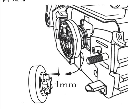
①ガイドバーを取り外した時に、クラッチドラム内側のソーチェン駆動スプロケットを点検してください。
