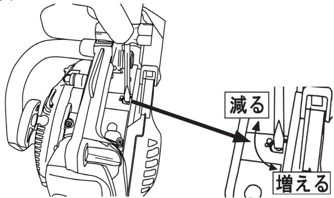
●オイル調整用マイナス溝は、閉め込んだ状態では決して使用しないでください。オイルポンプ破損の原因になります。
