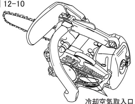
このエンジンは強制空冷式です。冷却用の空気取入口やシリンダーフィンの間にゴミが詰まると冷却不良によりエンジンが過熱し、故障の原因となります。時々点検し、ゴミを取り除いてください。
