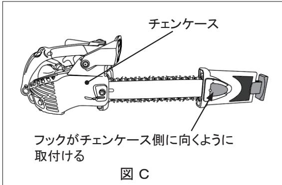
バーマウントシャープナーを装着する際は、図Cのように必ずフックがチェンケース側に向くように取付けてください。
