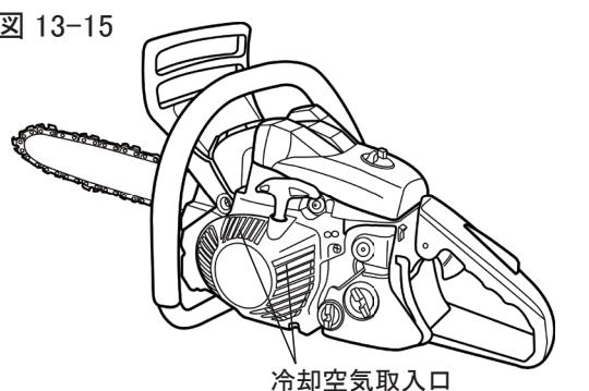
このエンジンは強制空冷式です。冷却用の空気取入口やシリンダフィンの間にゴミが詰まると冷却不良によりエンジンが過熱し、故障の原因となります。時々点検し、ゴミを取除いてください。
