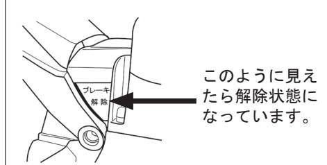
チェンブレーキは、使用中にガイドバーの先端が障害物に当たって上方にハネ返された（キックバック現象）際に、ブレーキが作動してソーチェンの回転を強制的に停止させる装置です。
