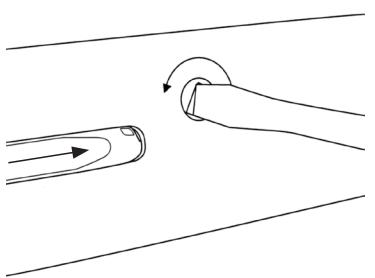
①ガイドバーのチェン張り調整穴に付属のコンビボックススパナを入れ、左に回してチェン張り調整をゆるめてください。
