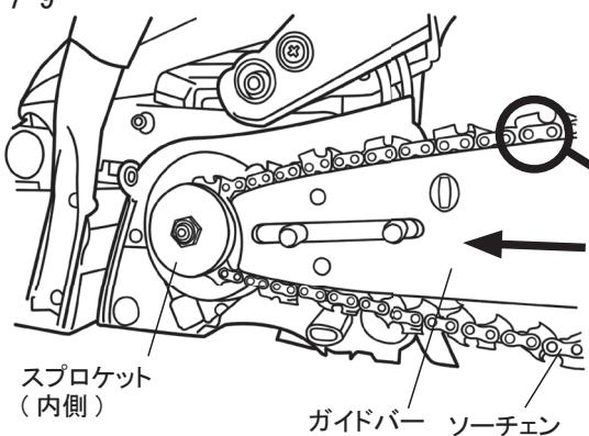
②ガイドバーを本体にセットした後、ソーチェンを正しい向きにスプロケットにかけてから、ガイドバーの溝にはめてください。
