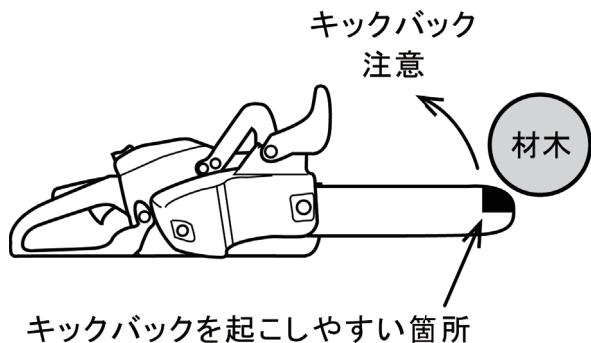
⑤切断中は、両手でフロントハンドルとリヤハンドルをチェンソーがぐらつかない程度に握って、切断物とガイドバー先端を見ながら操作してください。
