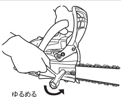
①ブレーキが解除されていることを確認して、付属のコンビボックススパナでガイドバー取付ナットをゆるめてください。（図 7-1 参照）
