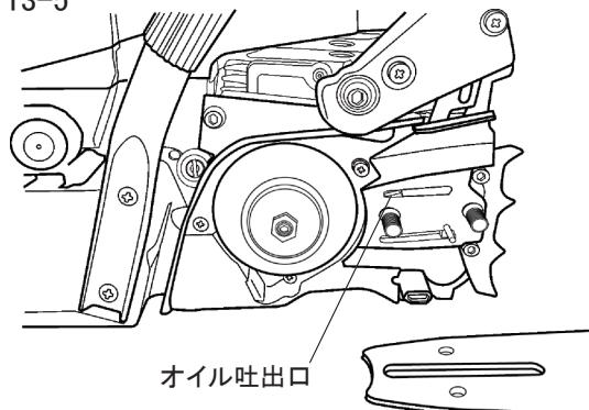
チェンオイルの供給不良を防ぐため、1日の作業が終った後にガイドバーとソーチェンを取り外して、チェンオイル吐出口周辺に付着しているゴミとガイドバー溝の底にたまつたゴミを、鉄板等で取除いてください。
