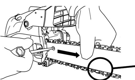
①ブレーキが解除されていることを確認して、付属のコンビボックススパナでガイドバー取付ナットをゆるめてください。(図 7-1 参照)
