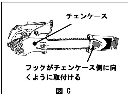
バーマウントシャープナーを装着する際は、図Cのように必ずフックがチェーンケース側に向くように取付けてください。
