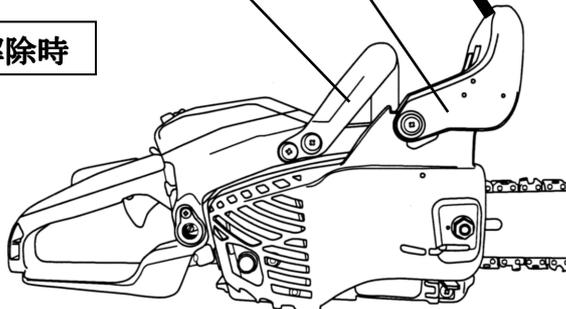
チェンブレーキは、使用中にガイドバーの先端が障害物に当たって上方にハネ返された際などに、ブレーキが作動してソーチェーンの回転を強制的に停止させる装置です。
