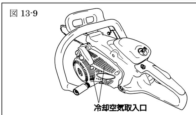
このエンジンは強制空冷式です。冷却用の空気取入口やシリンダフィンの中にゴミが詰まるとエンジンの冷却不良が発生し、エンジンが過熱し、故障の原因となります。時々、点検しゴミを取除いてください。
