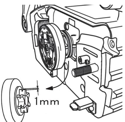
①ガイドバーを取外した時に、クラッチドラム内側のソーチェン駆動スプロケットを点検してください。
