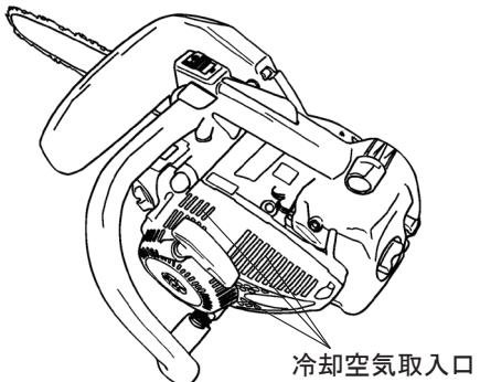
このエンジンは強制空冷式です。冷却用の空気取入口やシリンダーフィンの間にゴミが詰まると冷却不良によりエンジンが過熱し、故障の原因となります。時々点検し、ゴミを取除いてください。
