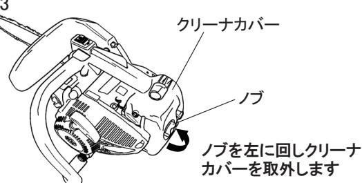
①機体後方のノブを左に回してゆるめ、クリーナカバーを後方に引いて取外してください。
