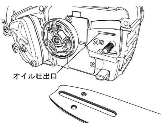
チェンオイルの供給不良を防ぐため、1日の作業が終った後にガイドバーとソーチェンを取り外して、チェンオイル吐出口周辺に付着しているゴミとガイドバー溝の底にたまつたゴミを、鉄板等で取除いてください。
