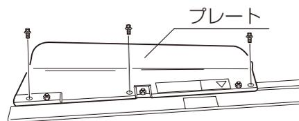
③プラグレンチでナットを緩め、⊕ドライバーでボルトを一杯まで締め込み、そこからボルトを1/4～1/2回転戻してください。その位置にボルトを固定して、確実にナットを締め付けてください。この時、ワッシャに遊びがあることを確認してください。
