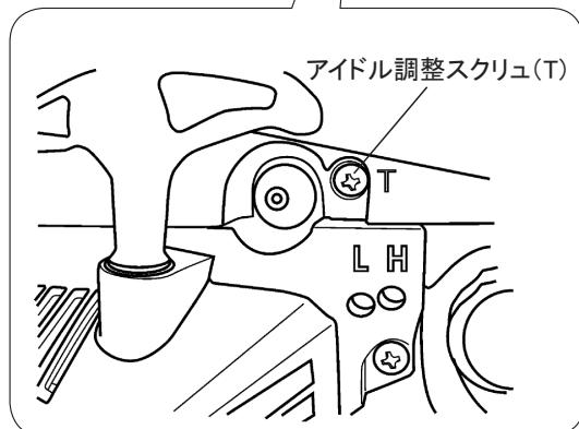
①本体中央左側部にあるアイドル調整スクリュ (T) を、付属のドライバで回してください。右に回すと回転が上がり、左に回すと回転が下がります。
