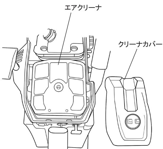
①その日の作業を始める前に、1日1回を目安に、クリーナカバーを外し、エアクリーナを取り外してゴミを取除いてください。
