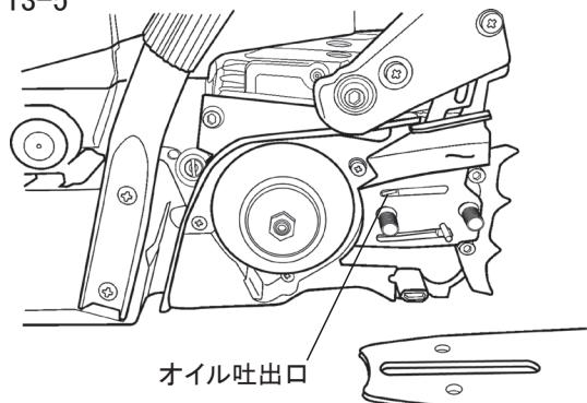
チェンオイルの供給不良を防ぐため、1日の作業が終った後にガイドバーとソーチェンを取り外して、チェンオイル吐出口周辺に付着しているゴミとガイドバー溝の底にたまつたゴミを、鉄板等で取除いてください。
