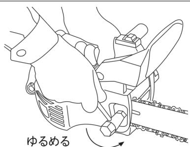
①付属のコンビボックススパナでガイドバー取付ナットをゆるめてください。(図 7-1 参照)
