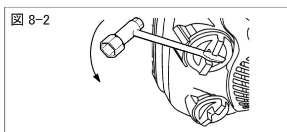
⑤給油が終わったらキャップを確実に締付け、漏れのないことを確認してください。
