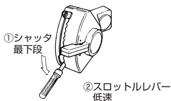
2 シャッターを閉じた状態で、スロットルレバーを軽く外側に押しながら最下段にしてエンジンを停止します。
