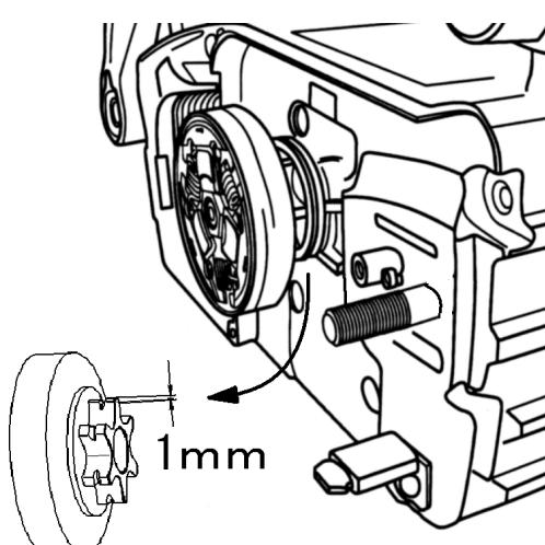
①ガイドバーを取り外した時に、クラッチドラム内側のソーチェン駆動スプロケットを点検してください。
