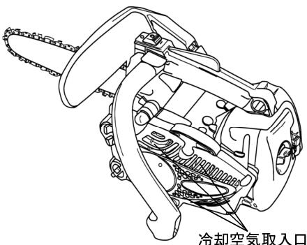
このエンジンは強制空冷式です。冷却用の空気取入口やシリンドラフィンの間にゴミが詰まるとエンジンの冷却不良が発生し、エンジンが過熱し、故障の原因となります。時々点検し、ゴミを取り除いてください。
