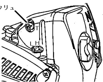
①後ハンドル左側後部にあるアイドル調整スクリュを付属のコンビボックススパナで回してください。右に回すとエンジン回転速度が上がり、左に回すとエンジン回転速度が下がります。
