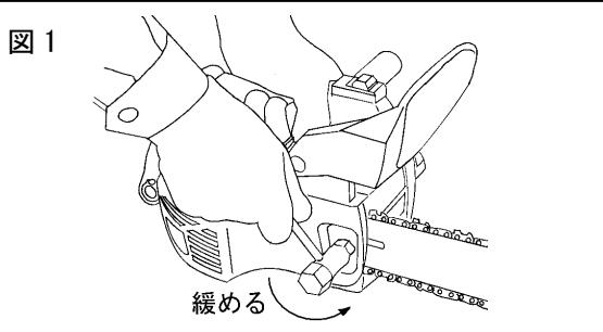
①付属のコンビボックススパナでガイドバー取付ナットを緩めてください。(図1参照)
