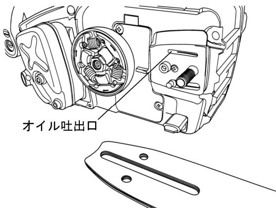
チェンオイルの供給不良を防ぐため、一日の作業が終った後、ガイドバーとソーチェンを取り外して、チェンオイル吐出口周辺に付着しているゴミとガイドバー溝の底にたまつたゴミを鉄板等で取り除いてください。
