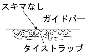
④ガイドバー先端部を持ち上げながら付属のボックススパナでガイドバー取付ナットを確実に締め付けてください。(図3参照)
