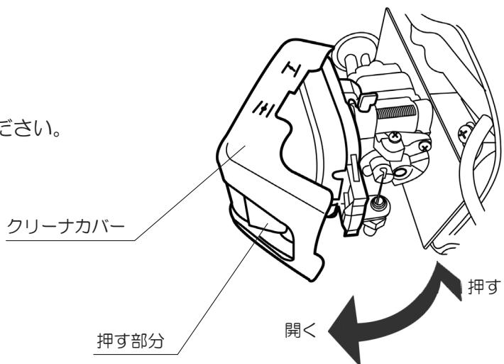
②エレメントを取り出し、切りクズを取除いてください。その後、ガソリンでよく洗浄し、よくしぼってから取付けてください。
