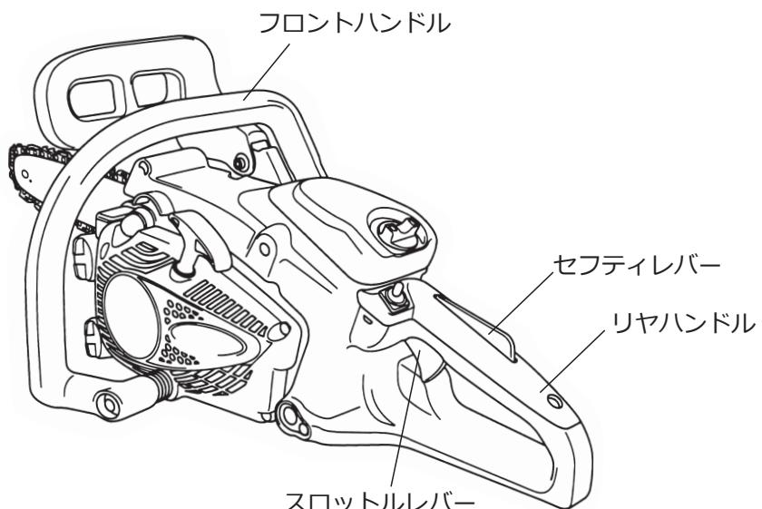
③ 切断中は、両手でフロントハンドルとリヤハンドルをチェンソーがぐらつかない程度に握って、切断物とガイドバー先端を見ながら操作してください。
