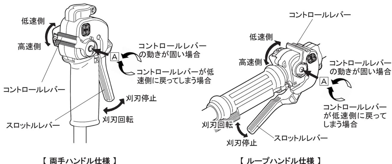
**メモ：**チップソーなど、金属刃使用の草刈作業では、エンジン全開回転速度の7～8割程度で行ってください。密生した草を刈るときやナイロンローター使用時はコントロールレバーを高速側いっぱいに調整し、エンジン回転を上げてください。
