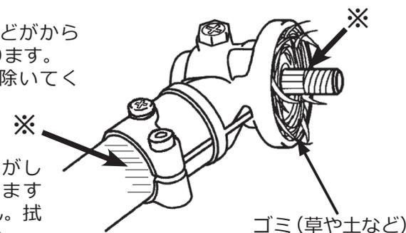
② 図のようにボルトを外し、刃物軸を図の矢印の方向に手で回しながら耐熱用のリチウム系グリスを注入口の口元まで注入して、ボルトを元通りに締め付けてください。(20 時間ごとに注入)
