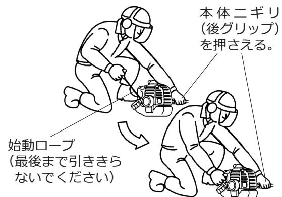
⑤ リコイルスタータノブをゆっくり引いてください。引いていくと、ロープに目印線が出てきます。その目印線まで引いて、ゆっくりスタータノブを戻してください。その後スタータノブを戻し始めるとき、そのことをスタータが感知してエンジン始動が始まります。
