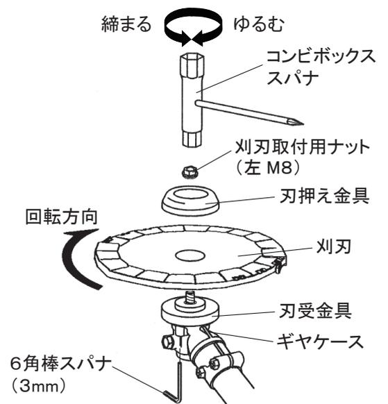
**メモ：** 付属のコンビボックススパナ以外の工具で締め付けないでください。刈刃取付用ナットおよびネジ部を破損する原因になります。
