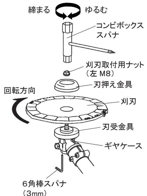
**メモ：**付属のコンビボックススパナ以外の工具で締め付けしないでください。刈刃取付用ナットおよびネジ部を破損する原因になります。
