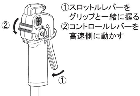
ブローなど金属製の刈刃使用時は、エンジン全開回転速度の7～8割程度、ナイロンローター使用時は、エンジン回転速度を全開にして作業を行ってください。
