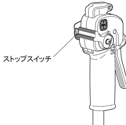
**注意** ・ここで実作業に入る前に、(2) エンジンの停止の項に従って、ストップスイッチを操作してエンジンが停止することを確認し、始動・停止の練習をしてください。
