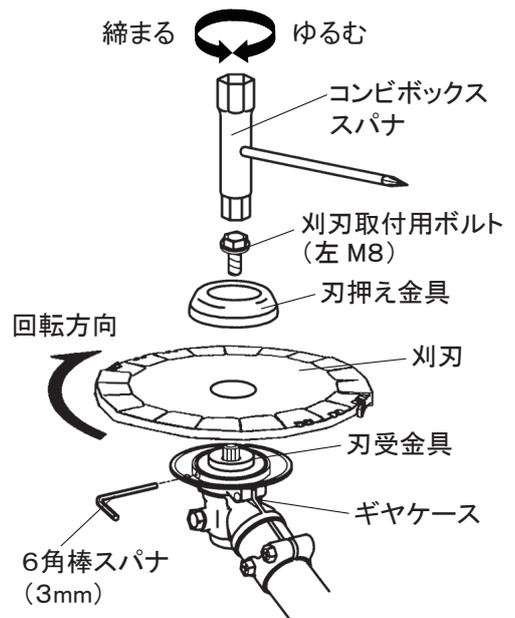
**メモ：** 付属のコンビボックススパナ以外の工具で締め付けしないでください。刈刃取付用ボルトおよびネジ部を破損する原因になります。
