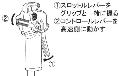
開回転速度の7~8割程度、ナイロンローター使用時は、エンジン回転速度を全開にして作業を行ってください。
