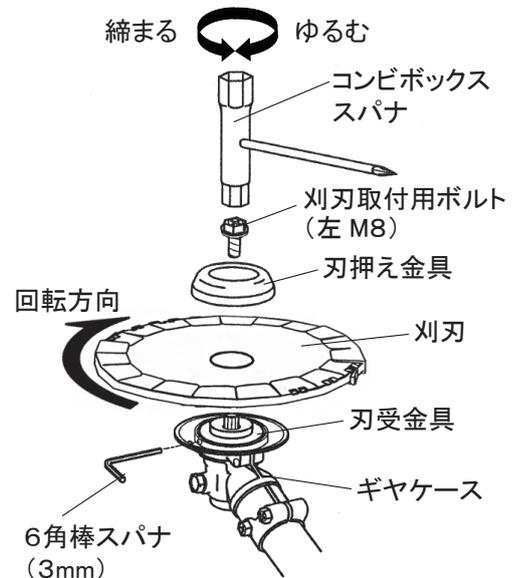
**メモ：** 付属のコンビボックススパナ以外の工具で締め付けしないでください。刈刃取付用ボルトおよびネジ部を破損する原因になります。
