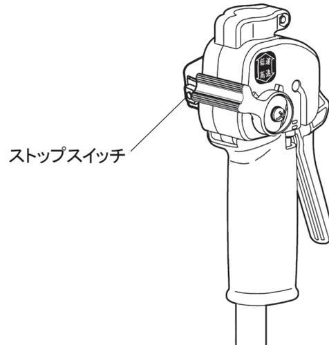
**注意** ・ここで実作業に入る前に、(2) エンジンの停止の項に従って、ストップスイッチを操作してエンジンが停止することを確認し、始動・停止の練習をしてください。
