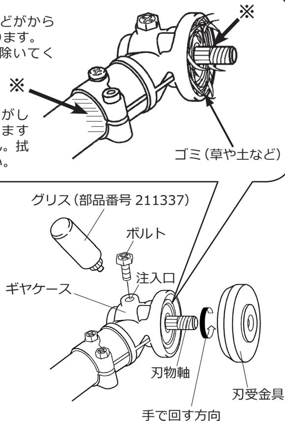
② 図のようにボルトを外し、刃物軸を図の矢印の方向に手で回しながら耐熱用のリチウム系グリスを注入口の口元まで注入して、ボルトを元通りに締め付けてください。(20 時間ごとに注入)
