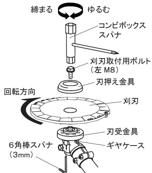
**メモ：**付属のコンビボックススパナ以外の工具で締め付けないでください。刈刃取付用ボルトおよびネジ部を破損する原因になります。
