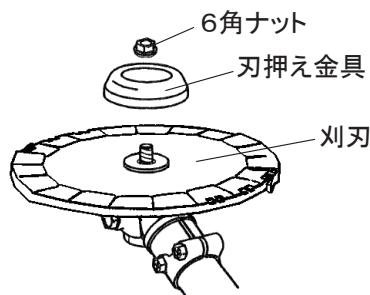
■ エンジン回転が低いままで作業すると、クラッチの異常加熱により故障の原因となります。チップソーなど金属製の刈刃使用時は、エンジン全開回転速度の7~8割程度、ナイロンローター使用時は、エンジン回転速度を全開にして作業を行ってください。
