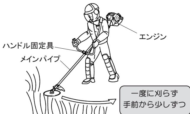
■ 刈刃が石などの硬いものに衝突したときは、ただちにエンジンを停止して刈刃を点検し、損傷のある場合は交換してください。また繰り返し衝撃を受けると、刈刃の損傷だけでなく、ギヤケースを破損する危険があります。
