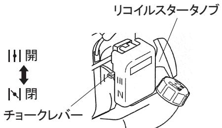
**③ 注意** リコイルスタートナブを数回勢いよく引いてください。爆発音がし、エンジンがすぐに止まったときは、チョークレバーを↑(開)にし、さらにスタートナブを引いて始動してください。爆発音を聞きのがして、チョークレバー↓(閉)のままリコイルスタートナブを何回も引き続けると、混合燃料がエンジンシリンダの中へ入り過ぎて、エンジンが始動できなくなります。
