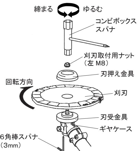
**メモ：**付属のコンビボックススパナ以外の工具で締め付け
