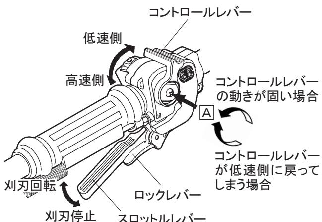
**メモ:**チップソーなど、金属刃使用の草刈作業では、エンジン全開回転速度の7~8割程度で行ってください。密生した草を刈るときやナイロンローター使用時はコントロールレバーを高速側いっぱいに調整し、エンジン回転を上げてください。
