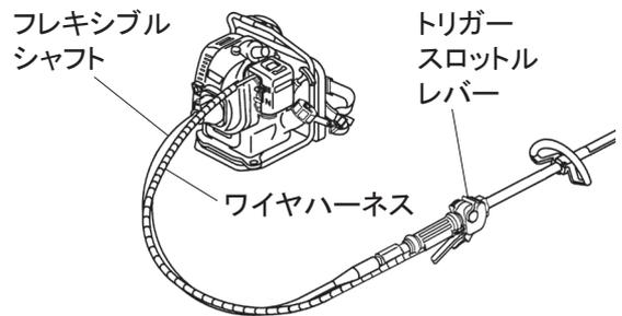
**メモ：**実際の使用状態に近づけてスロットルワイヤの遊び調整をするためです。フレキシブルシャフトの曲げ具合も実際の使用状態を想定して曲げてください。
