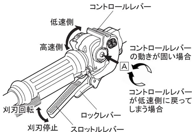
**メモ**：チップソーなど、金属刃使用の草刈作業では、エンジン全開回転速度の7～8割程度で行ってください。密生した草を刈るときやナイロンローター使用時はコントロールレバーを高速側いっばいに調整し、エンジン回転を上げてください。
