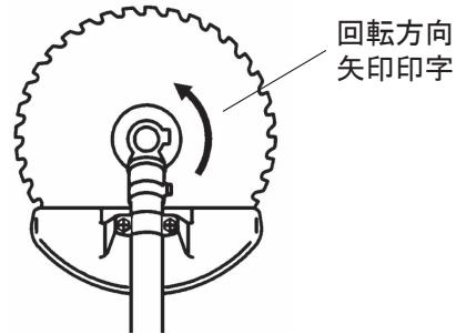
① 刃受金具に6角棒スパナ（3mm）を差し込み、刃受金具を回らなくしてから刃刃取付用ナットを付属のコンビボックススパナで右に回してゆるめてください。刃刃取付用ナットと刃押え金具を外してください。
