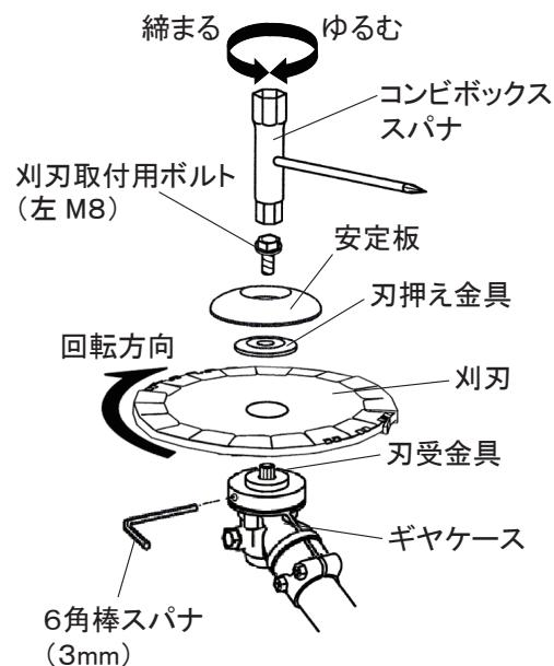
**メモ：**付属のコンビボックススパナ以外の工具で締め付けてください。刈刃取付用ボルトおよびネジ部を破損する原因になります。
