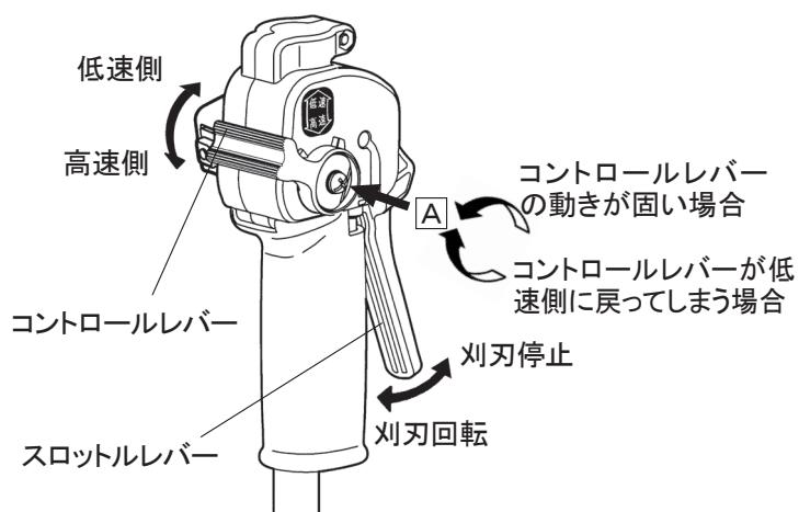
**メモ:** チップソーなど、金属刃使用の草刈作業では、エンジン全開回転速度の7~8割程度で行ってください。密生した草を刈るときやナイロンローター使用時はコントロールレバーを高速側いっぱいに調整し、エンジン回転を上げてください。
