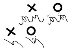
粗悪な刈刃、ソーチェン、耕作刃を使用すると障害物に当たったときなどに、刃先が折損し作業者に向かって飛んできて、死傷や失明などの重大事故が起きる危険があります。
