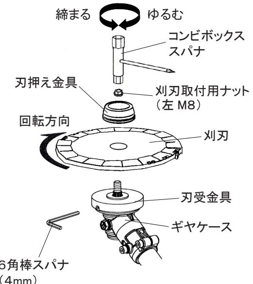
**メモ:** 付属のコンビボックススパナ以外の工具で締め付けないでください。刈刃取付用ナットおよびネジ部を破損する原因になります。
