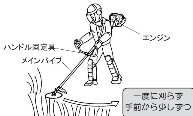
■ エンジン回転が低いままで作業すると、クラッチの異常加熱により故障の原因となります。チップソーなど金属製の刈刃使用時は、エンジン全開回転速度の7~8割程度、ナイロンローター使用時は、エンジン回転速度を全開にして作業を行ってください。
