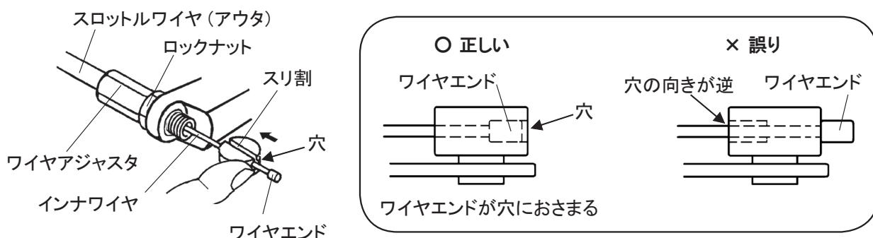
② スロットルワイヤの取付が終わったら必ずコントロールレバーとスロットルレバーを操作し、動作の確認を行ってください。スロットルレバーから手を離した際、キャブレタの扇状部品がアイドルスクリュに接していることを確認してください。扇状部品とアイドルスクリュの間にすき間がある場合、スロットルワイヤ（アウタ）がトリガースロットルレバーの穴の奥まで入っていない可能性があります。再度ワイヤの取付を確認してください。
