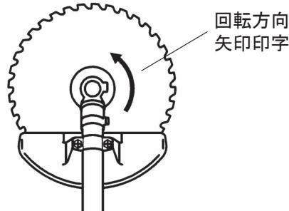
① 刃受金具に6角棒スパナ（4mm）を差し込み、刃受金具を回らなくしてから刈刃取付用ナットを付属のコンビボックススパナで右に回してゆるめてください。刈刃取付用ナットと刃押え金具を外してください。
