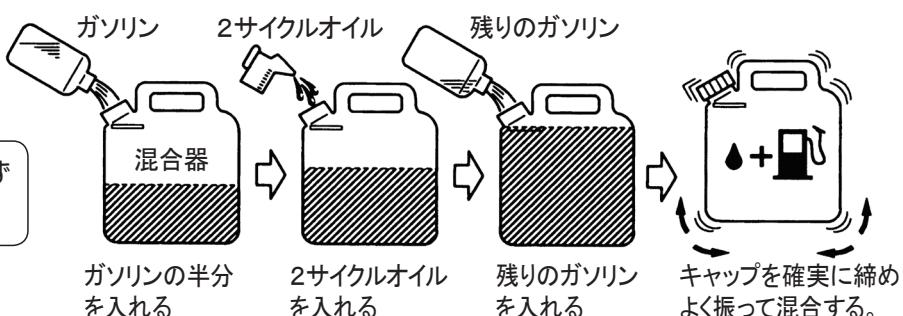
〈2〉 燃料タンクに混合燃料を少しずつ、ゆっくりと入れてください。混合燃料は燃料タンクいっぱいに入れないで、8分目（給油口先端より約2cm）を目安にしてください。
