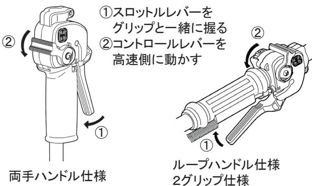
ど金属製の刈刃使用時は、エンジン全開回転速度の7~8割程度、ナイロンローター使用時は、エンジン回転速度を全開にして作業を行ってください。
