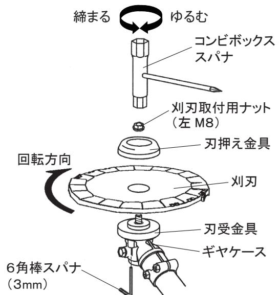
**メモ:** 付属のコンビボックススパナ以外の工具で締め付けないでください。刃刃取付用ナットおよびネジ部を破損する原因になります。
