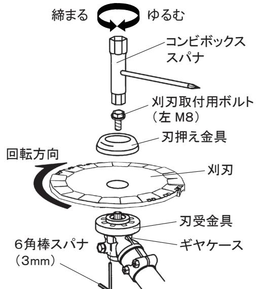
**メモ**：付属のコンビボックススパナ以外の工具で締め付けないでください。刈刃取付用ボルトおよびネジ部を破損する原因になります。
