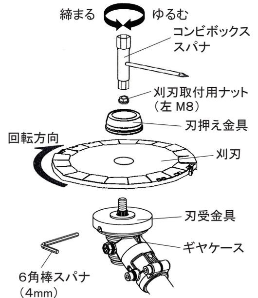
**メモ：** 付属のコンビボックススパナ以外の工具で締め付けないでください。刈刃取付用ナットおよびネジ部を破損する原因になります。
