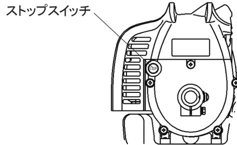
**⚠ 注意** ・ここで実作業に入る前に、(2) エンジンの停止の項に従って、ストップスイッチを操作してエンジンが停止することを確認し、始動・停止の練習をしてください。
