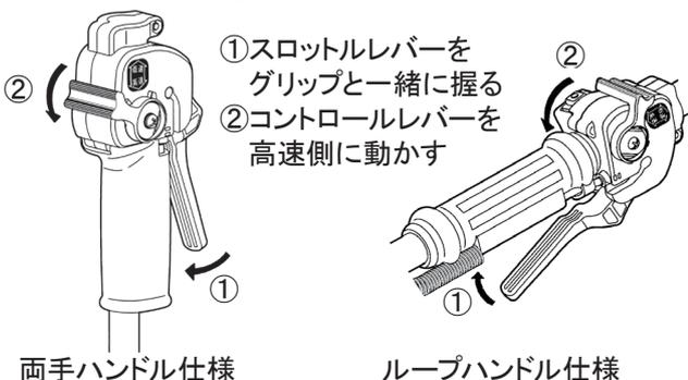
開回転速度の7～8割程度、ナイロンローター使用時は、エンジン回転速度を全開にして作業を行ってください。
