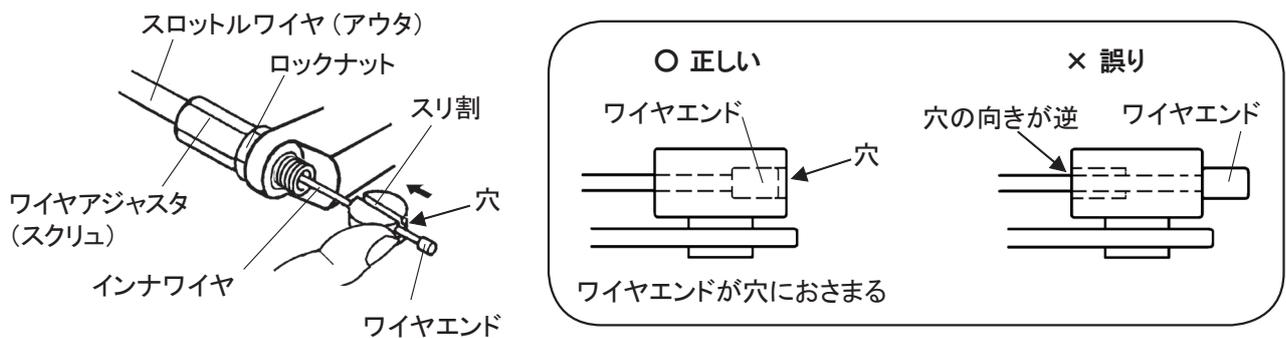
② スロットルワイヤの取付が終わったら必ずコントロールレバーとスロットルレバーを操作し、動作の確認を行ってください。スロットルレバーから手を離れた際、キャブレタの扇状部品がアイドルスクリュに接していることを確認してください。扇状部品とアイドルスクリュの間にすき間がある場合、スロットルワイヤ（アウト）がトリガースロットルレバーの穴の奥まで入っていない可能性があります。再度ワイヤの取付を確認してください。
