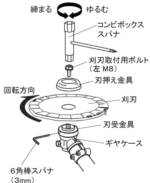
**メモ**：付属のコンビボックススパナ以外の工具で締め付けないでください。刈刃取付用ボルトおよびネジ部を破損する原因になります。
