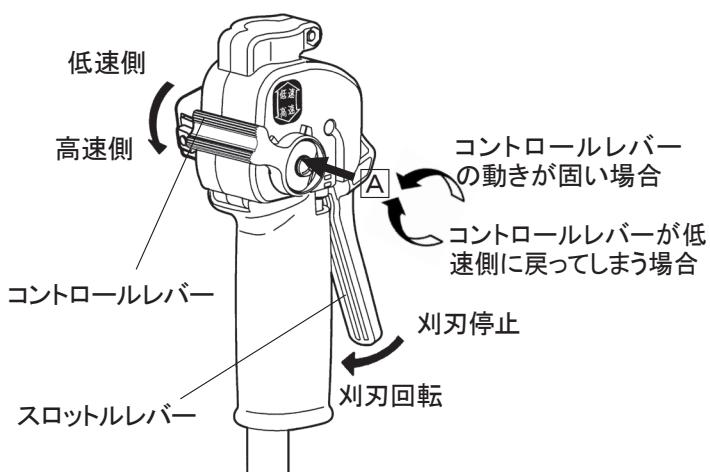
**メモ:** チップソーなど、金属刃使用の草刈作業では、エンジン全開回転速度の7~8割程度で行ってください。密生した草を刈るときやナイロンローター使用時はコントロールレバーを高速側いっぱいに調整し、エンジン回転を上げてください。
