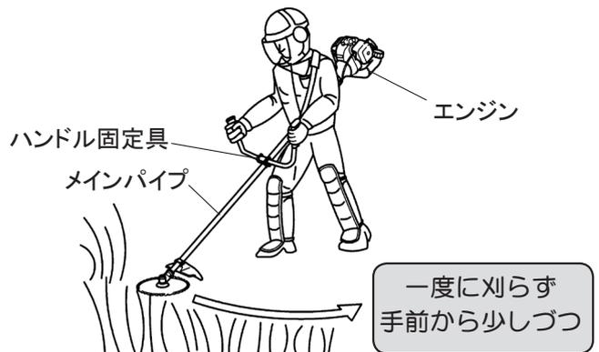
■ 刈刃が石などの硬いものに衝突したときは、すぐにエンジンを停止して刈刃を点検し、損傷のある場合は交換してください。また繰返し衝撃を受けると、刈刃の損傷だけでなく、ギヤケースを破損する危険があります。
