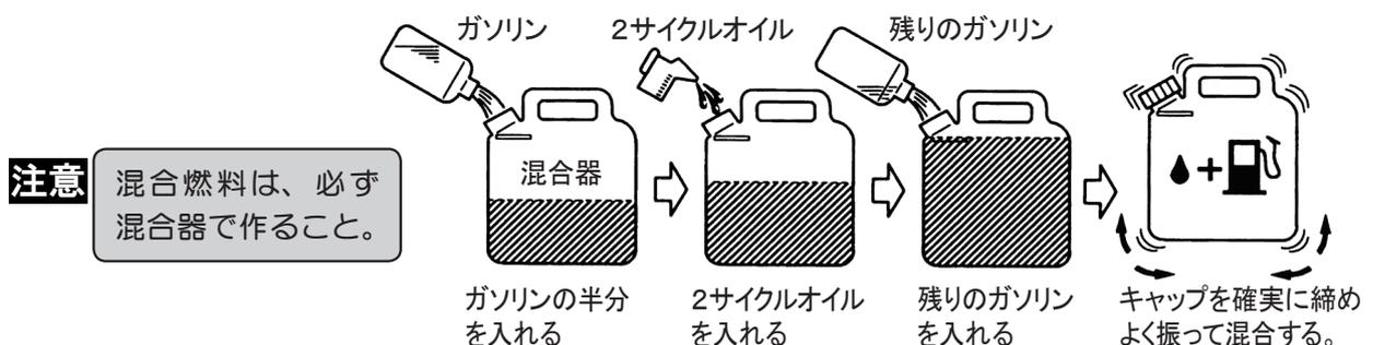
〈2〉燃料タンクに混合燃料を少しずつ、ゆっくりと入れてください。混合燃料は燃料タンクいっぱいに入れないで、8分目（給油口先端より約2cm）を目安にしてください。
