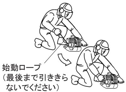
④ エンジンが始動したら、トリガースロットルレバーを操作せずに（アイドリング位置のまま）、1～2分間暖機運転をしてください。
