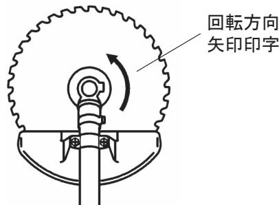
① 刈受金具に6角棒スパナ（3mm）を差し込み、刈受金具を回らなくしてから刈刃取付用ボルトを付属のコンビボックススパナで右に回してゆるめてください。刈刃取付用ボルトと刃押え金具を外してください。
