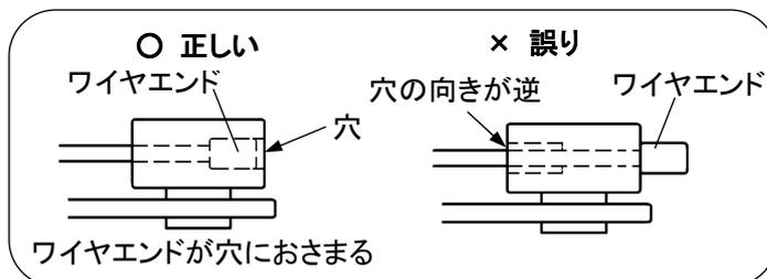
\* 下図のように、ワイヤエンドがスリ割の穴に届かない場合、スロットルワイヤ(アウト)がガイド部分から外れている、もしくはスロットルワイヤ(アウト)とガイド部分端面にスキマがあることが考えられます。スロットルワイヤ(アウト)を刈刃側に押し込んでから再度取付けを行ってください。
