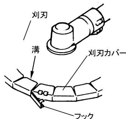
① 刈刃の刃先を刈刃カバーの溝に押し込んで、フックで固定してください。
