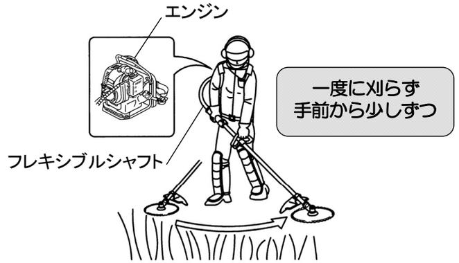
■ 刈刃が石等の硬いものに衝突したときは、すぐにエンジンを停止して刈刃を点検し、損傷のある場合は交換してください。また繰り返し衝撃を受けると、刈刃の損傷だけでなく、ギャケースを破損する危険があります。
