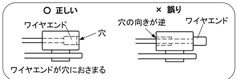
③ スロットルワイヤの取り付けが終わったら必ずコントロールレバーとスロットルレバーを操作し、動作の確認を行ってください。スロットルレバーを手から離れた際、キャブレタの扇状部品がアイドルスクリュに接していることを確認してください。扇状部品とアイドルスクリュの間にすき間がある場合、スロットルワイヤ(アウタ)がトリガースロットルレバーの穴の奥まで入っていない可能性があります。再度ワイヤの取り付けを確認してください。
