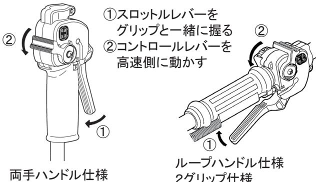
開回転速度の7~8割程度、ナイロンローター使用時は、エンジン回転速度を全開にして作業を行ってください。
