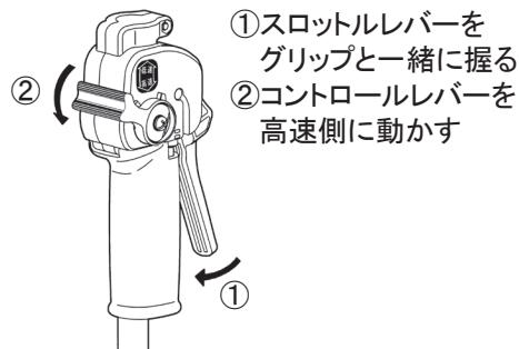
ど金属製の刈刃使用時は、エンジン全開回転速度の7~8割程度、ナイロンローター使用時は、エンジン回転速度を全開にして作業を行ってください。
