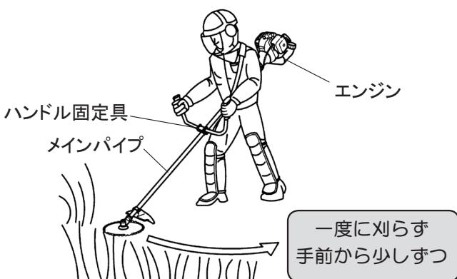
■ 刈刃が石等の硬いものに衝突したときは、すぐにエンジンを停止して刈刃を点検し、損傷のある場合は交換してください。また繰り返し衝撃を受けると、刈刃の損傷だけでなく、ギヤケースを破損する危険があります。
