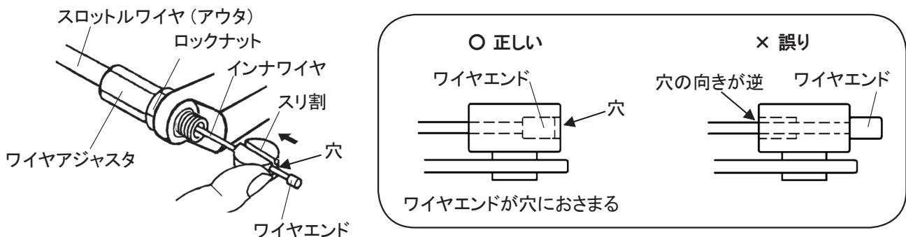
③ スロットルワイヤの取り付けが終わったら必ずコントロールレバーとスロットルレバーを操作し、動作の確認を行ってください。スロットルレバーから手を離した際、キャブレタの扇状部品がアイドルスクリュに接していることを確認してください。扇状部品とアイドルスクリュの間にすき間がある場合、スロットルワイヤ（アウタ）がトリガースロットルレバーの穴の奥まで入っていない可能性があります。再度ワイヤの取り付けを確認してください。
