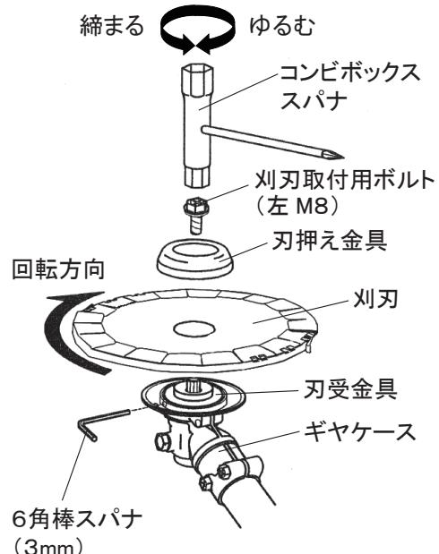
**メモ**：付属のコンビボックススパナ以外の工具で締め付けないでください。刈刃取付用ボルトおよびネジ部を破損する原因になります。
