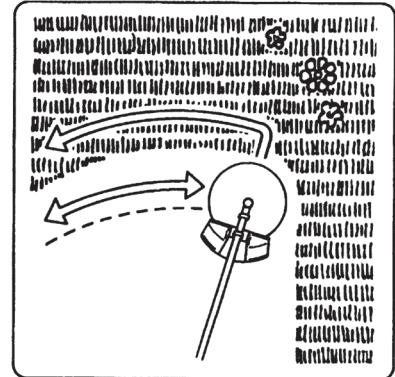
**メモ：** 刈刃は地面に対し  $10^{\circ}$  くらい左下がりにして腰を中心にして、刈刃を地面に平行に動かして刈る方法が基本的な方法です。
