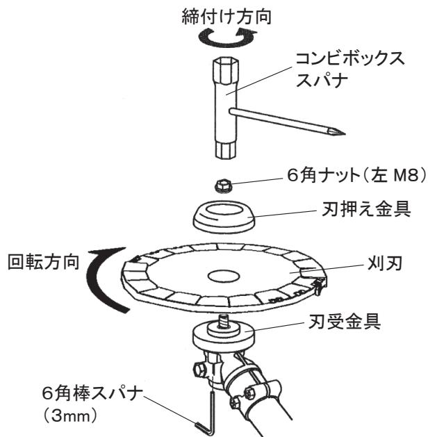
③ 刈受金具の凸部と刈刃の取付け穴を合わせてください。刈刃、刃押え金具、6角ナット（左M8）
