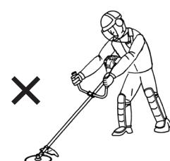
■ 刈刃(金属刃)の動かし方は、右から左に操作してください。逆に左から右へ操作すると【キックバック】により危険な現象が起きます。この操作は、しないでください。
