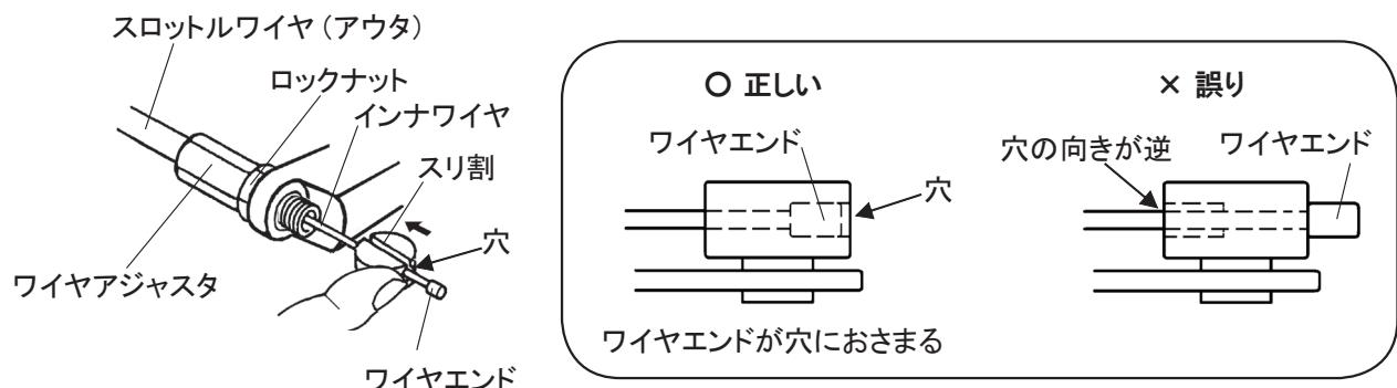
③ スロットルワイヤの取り付けが終わったら必ずコントロールレバーとスロットルレバーを操作し、動作の確認を行ってください。スロットルレバーから手を離した際、キャブレタの扇状部品がアイドルスクリュに接していることを確認してください。扇状部品とアイドルスクリュの間にすき間がある場合、スロットルワイヤ（アウタ）がトリガースロットルレバーの穴の奥まで入っていない可能性があります。再度ワイヤの取り付けを確認してください。
