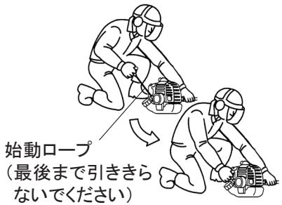
④ エンジンが始またら、トリガースロットルレバーを操作せずに（アイドリング位置のまま）、1～2分間暖機運転をしてください。
